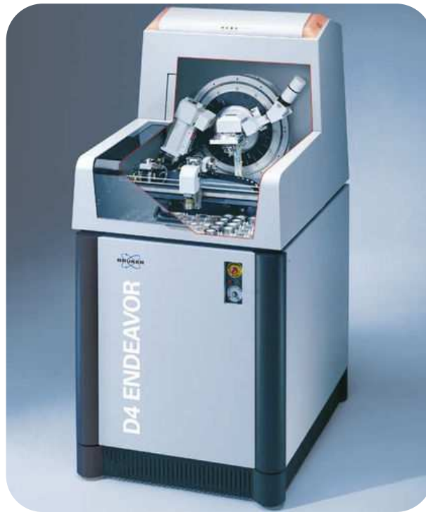
Figure III.9 : Schéma de dispositif de DRX (D4 ENDEAVOR)
