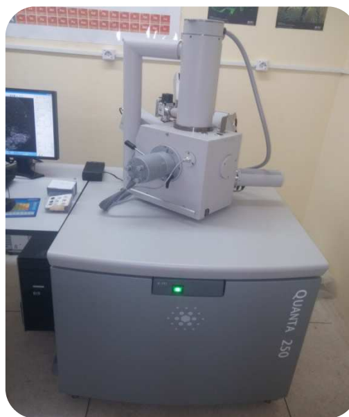
Figure III.7 : Schéma de dispositif de MEB (EDAX METEK QUANTA 250)
